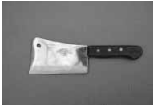
Fig. 4 - Il manarese, o coltello/ascia spaccossa, è un attrezzo tutt'fare che serve quando, oltre a dover tagliare, si deve anche spaccare qualcosa di molto consistente come le ossa e i tendini degli animali macellati. Per far questo è necessario che il suo peso lo consenta e ciò è ottenuto sia dal forte spessore della lama sia dal disegno squadrato di questa che sposta il baricentro molto in avanti, aumentandone l'efficacia.
