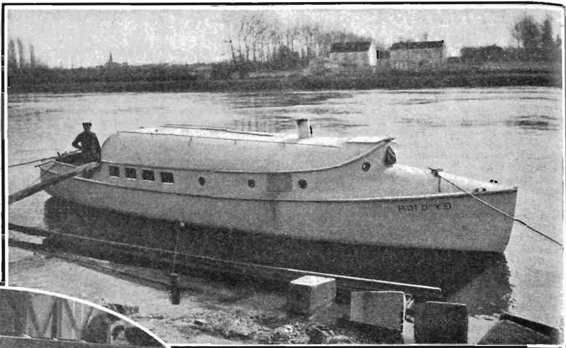
Le Roi d'Ys, cruiser di 10 metri e 60, munito di motore Panhard.
